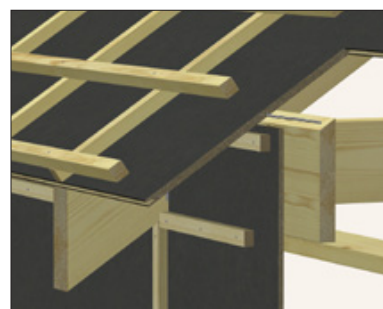
Övergång vägg/tak med utstickande takstolar/takbalkar
